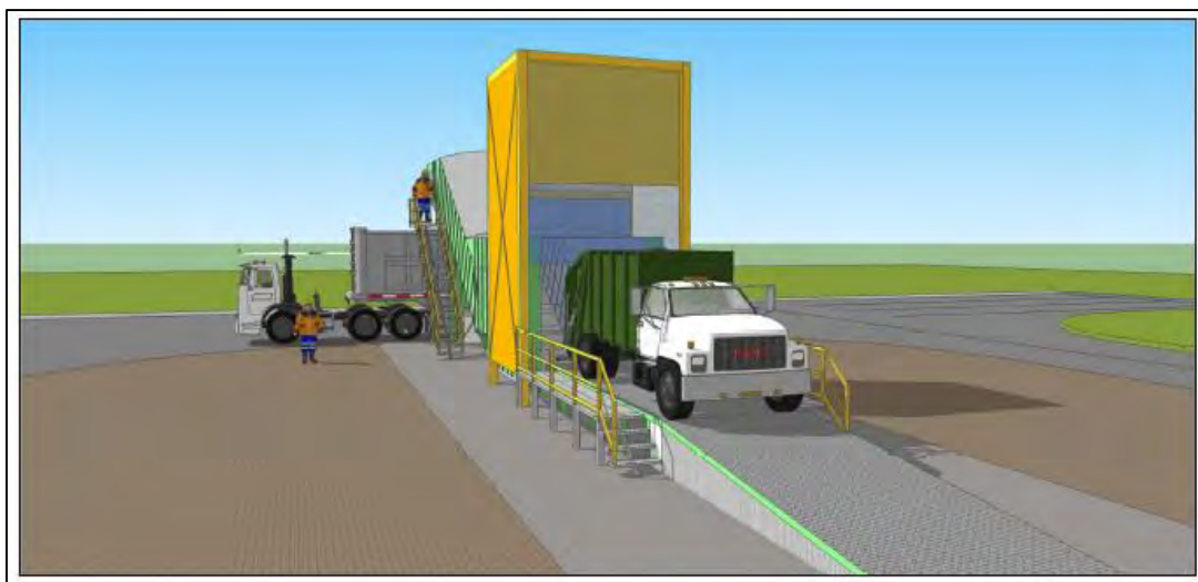
Slika 2.3.-3. Utovarni dio pretovarne rampe
